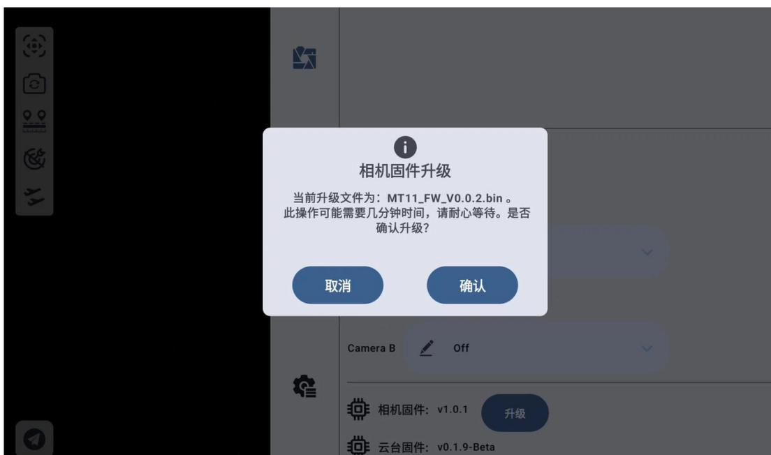
3. 确定固件没问题后，点击确定进入传输界面。第一行是云台固件传输进度条，第二行是相机固件传输进度条，两个固件会依次进行传输升级。升级云台固件时云台会失去增稳，升级完成后增稳恢复。
