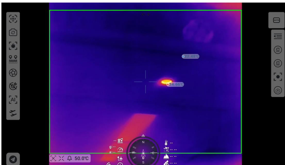
区域测温或全局测温时会显示报警温度,点击报警温度可以设置报警温度,使用高温报警功能。
