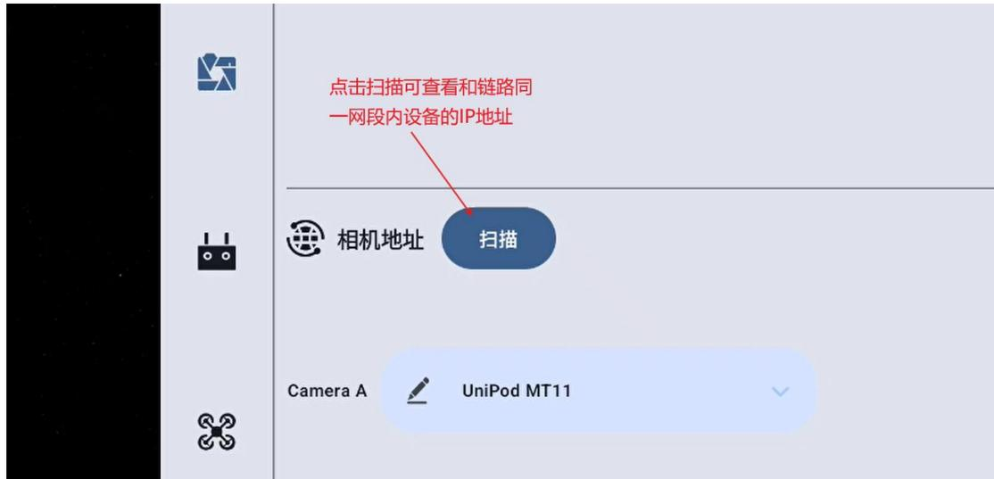
点击对应 IP 地址即可使用修改后的 IP 地址出图，点击复位按钮，吊舱恢复默认 IP 地址。
